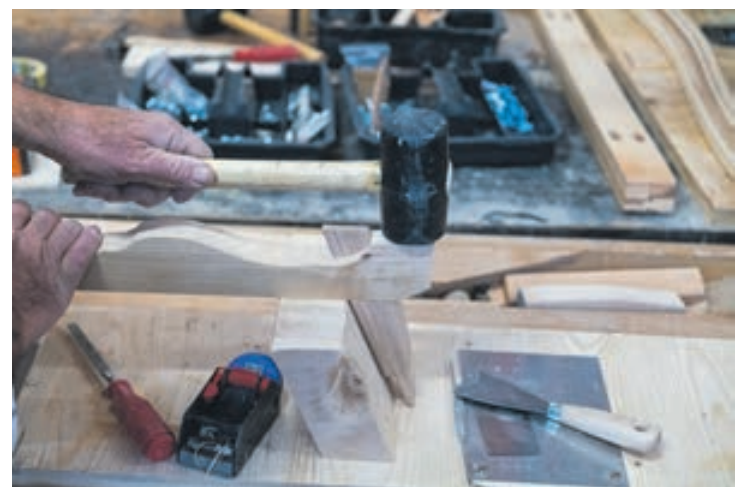
Pour les patins de la luge, l'artisan utilise de fines planches qu'il colle, cintre et scie. Les autres éléments – longerons, chevalets et traverses – sont taillés, rabotés, poncés. Le tout peut ensuite être verni et assemblé.
