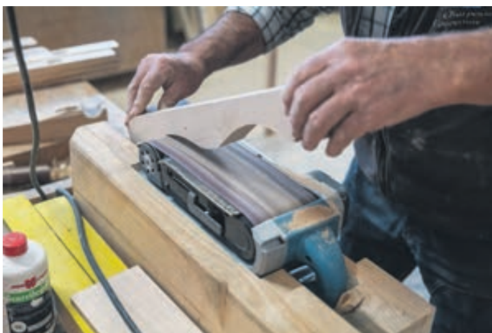
Pour les patins de la luge, l'artisan utilise de fines planches qu'il colle, cintre et scie. Les autres éléments – longerons, chevalets et traverses – sont taillés, rabotés, poncés. Le tout peut ensuite être verni et assemblé.
