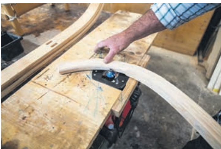
Pour les patins de la luge, l'artisan utilise de fines planches qu'il colle, cintre et scie. Les autres éléments – longerons, chevalets et traverses – sont taillés, rabotés, poncés. Le tout peut ensuite être verni et assemblé.
