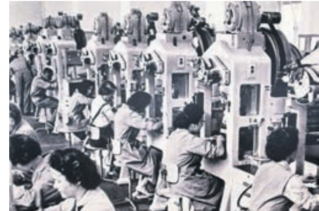
Etampage (formation et découpage de pièces d'horlogerie) chez Omega en 1960.
