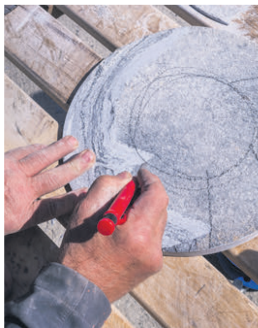
Des gestes du métier. Première ébauche avant la découpe et l'opération de polissage. Un dernier travail effectué par Brice Sarrasin. Il lui faudra quatre à six heures, selon la taille de l'objet, pour terminer cette étape.
