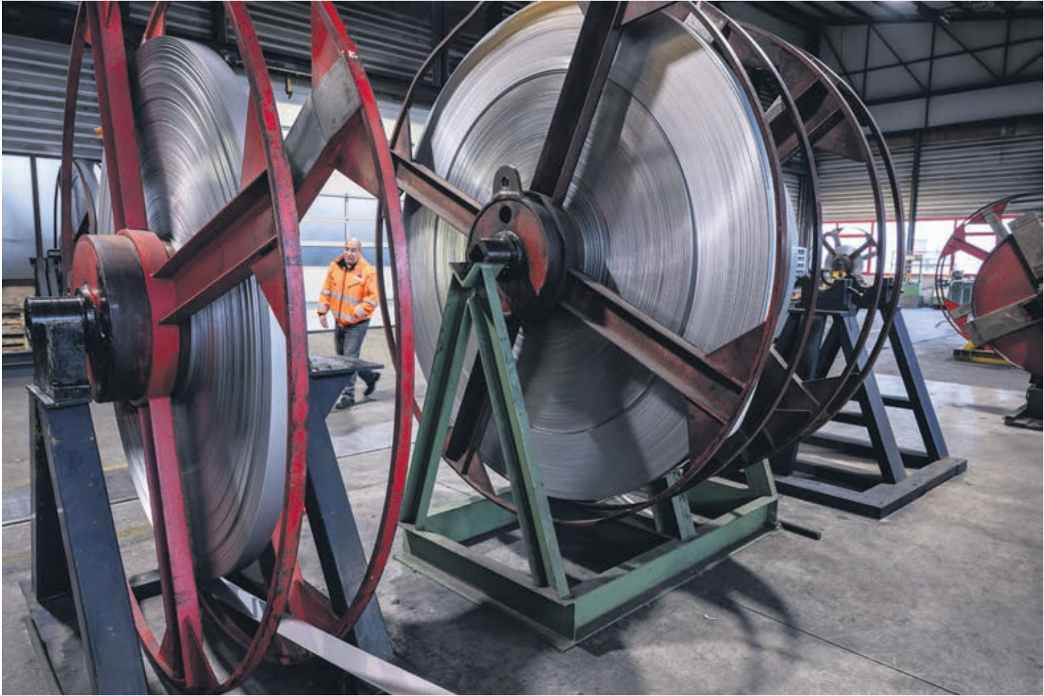
Le processus commence avec la matière brute: les bobines d'inox. Puis, peu à peu, le tube se forme, avec une soudure interne.
