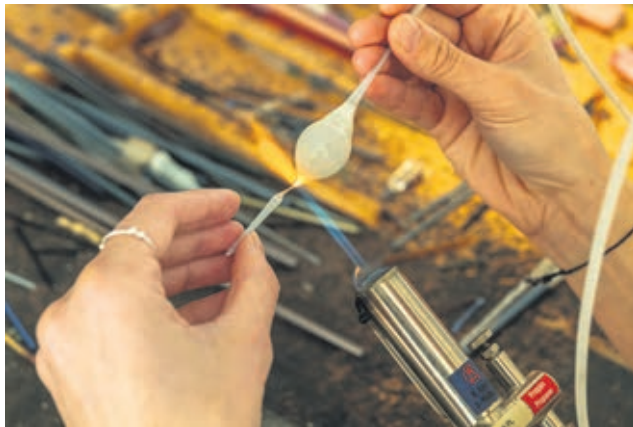
Passé sur la flamme, le verre fond et une sphère se forme sous l'impulsion du souffle de l'artisanne, induit à travers un fin tuyau en plastique.
