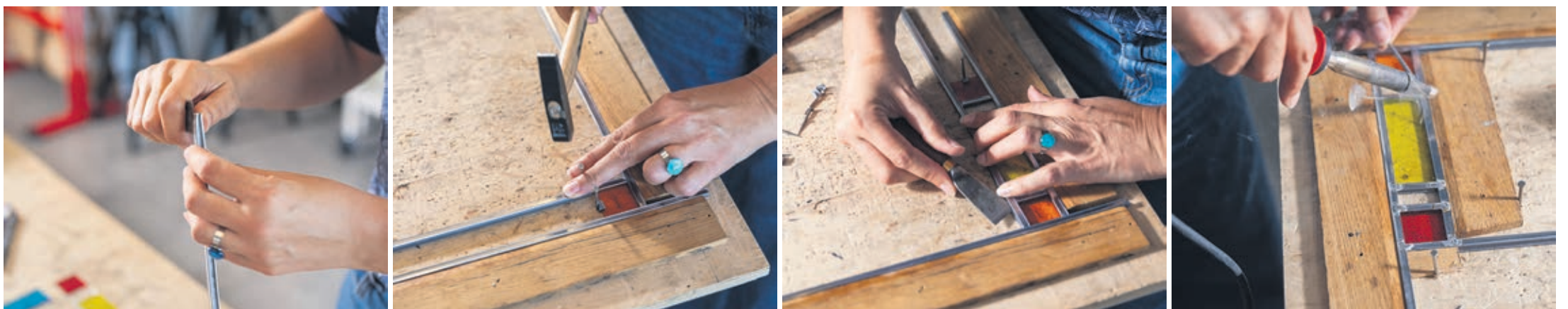
L'artisane élargit les ailes de la baguette de plomb qui viendra emprisonner le verre. Le fragment est d'abord calé pour éviter tout mouvement avant d'être fixé dans le métal. Les jointures sont solidifiées avec un fer à souder.
