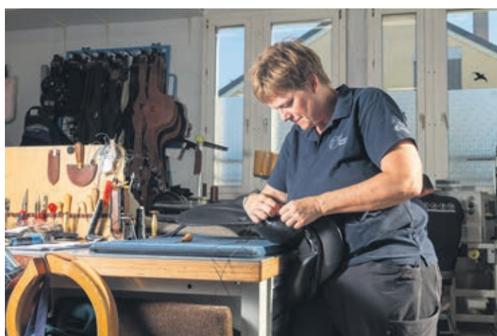
Phase de couture qui permet de joindre le quartier de selle à l'arçon.
