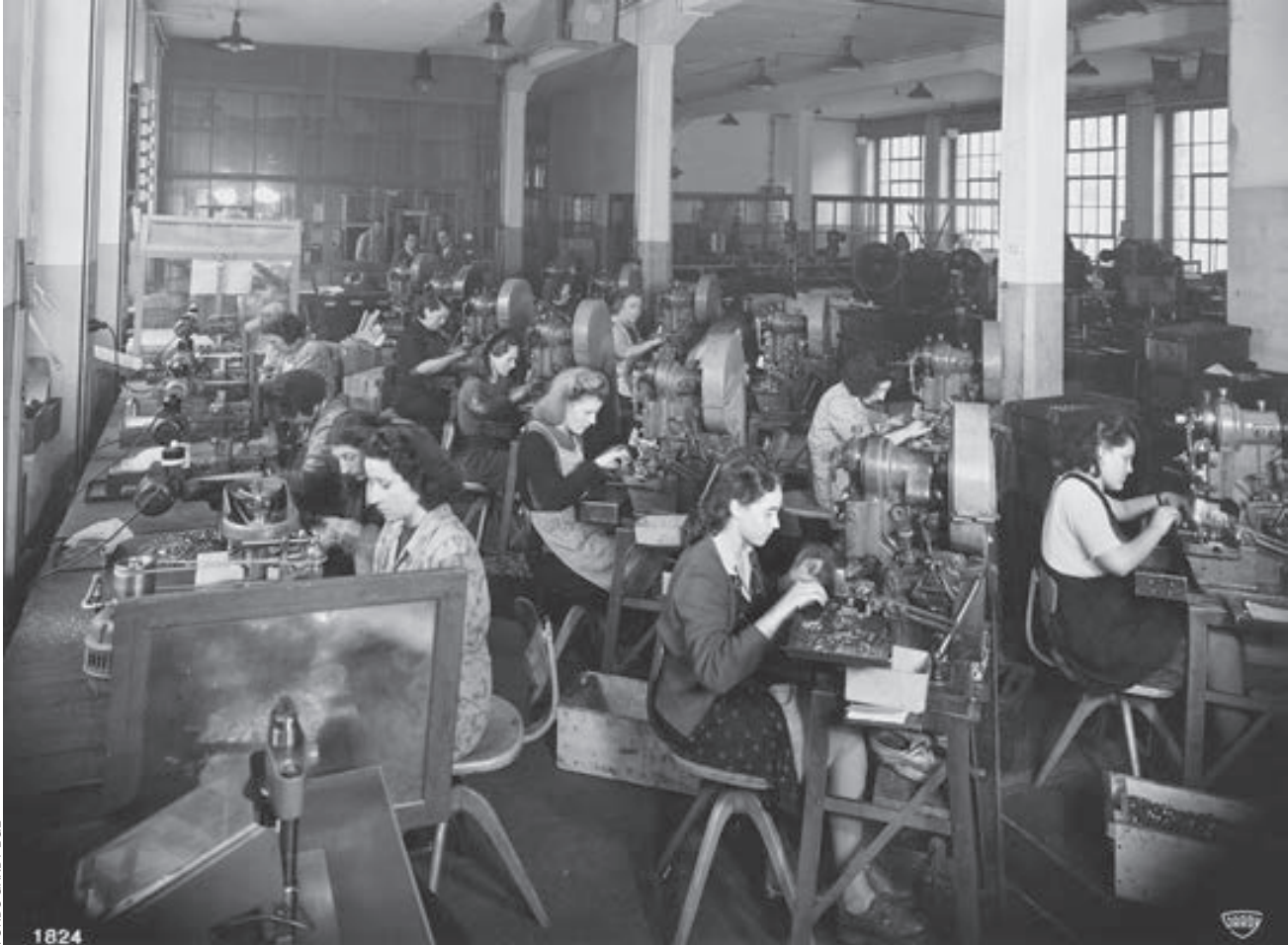
Atelier des petites presses pour la production de pièces destinées à l'appareillage électrique, 1948.
