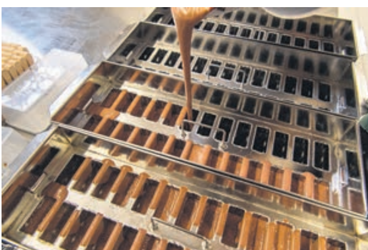
Remplissage des moules.
