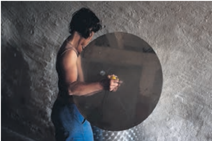
Pendant notre présence, Céline Ammann se lance dans une cuve d'indigo, un procédé délicat dans le monde de la teinture. Le pigment d'indigo redevient soluble dans l'eau grâce à un mélange précis avec de la chaux et du fructose.
