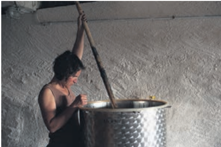
Pendant notre présence, Céline Ammann se lance dans une cuve d'indigo, un procédé délicat dans le monde de la teinture. Le pigment d'indigo redevient soluble dans l'eau grâce à un mélange précis avec de la chaux et du fructose.
